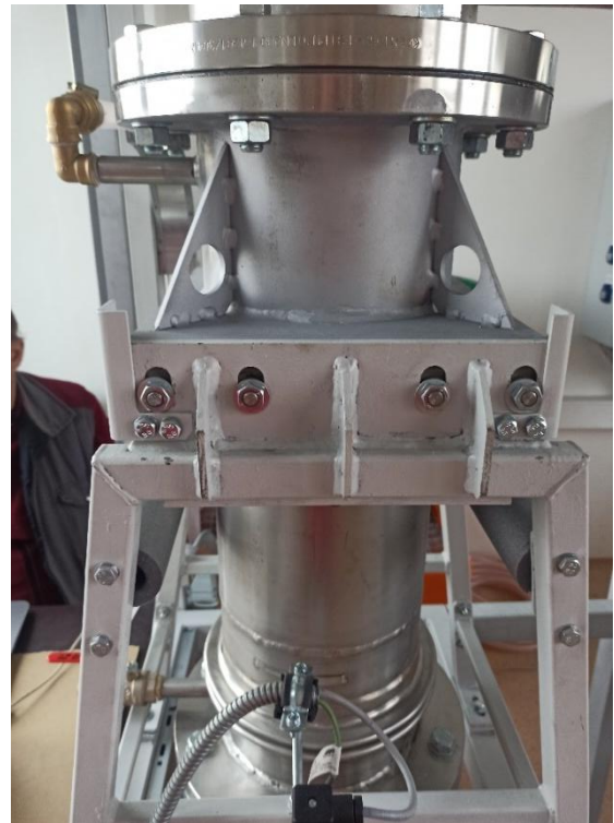
Obrázek 3: Kondenzační chladič laboratorní pyrolyzní jednotky (ilustrační obr.)
